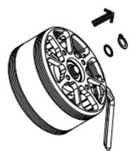
2、双手分别握住电机的定子组件和转子组件，用力向外拉，将电机转子组件与定子组件分离；注意外拉过程中用力要均衡，因电机磁钢与定子铁芯吸力较强，外拉过程中小心夹手。如图所示
