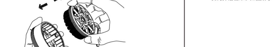
2、把螺旋桨的中心孔与电机端盖定位轴对齐放置，最后用4颗M3\*10内六角沉头螺钉将螺旋桨压板和螺旋桨锁紧在电机端盖上。如图所示
