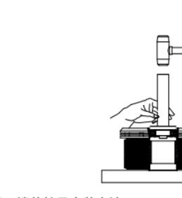
3、端盖轴承拆卸方法：准备好相同规格的轴承，然后将拆完轴承的定子组件水平放置在工作台上，下面用细软的材料垫起，保护漆包线不得受伤，或者用平整得垫片避开漆包线，垫起轴承部位。用轴承安装顶杆，与轴承内孔相匹配的一端，固定好轴承，放置在定子轴承孔内。轴承与安装面保持平行，确保与轴承孔同轴，用橡胶锤轻轻敲顶杆，直到轴承安装到位。如图所示。
