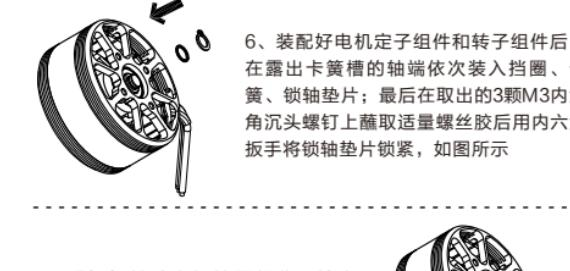
6、装配好电机定子组件和转子组件后，在露出卡簧槽的轴端依次装入挡圈、卡簧、锁轴垫片；最后在取出的3颗M3内六角沉头螺钉上蘸取适量螺丝胶后用内六角扳手将锁轴垫片锁紧，如图所示
