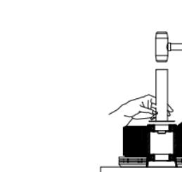
4、端盖轴承安装方法：双手把电机定子组件端平，轴承端面正对上方，另一人把轴承拆卸顶杆小端从轴承孔内放入，倾斜10度左右顶住靠安装面端轴承的一个边缘，手抓住顶杆，用橡胶锤轻敲轴承拆卸顶杆；然后换到另一边，再敲击，两侧平衡敲击，如此循环动作，使轴承顺畅的从轴承孔内掉落出来。如图所示。
