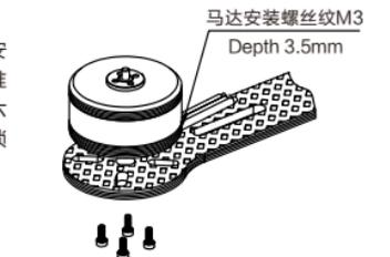
2、把螺旋桨固定座螺纹端朝上，固定座底端孔对齐电机端盖的定位轴，用4颗M3\*5内六角圆柱头螺钉将固定座锁紧在电机上；然后把螺旋桨的中心
